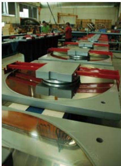
Una fase di produzione dei dispositivi antisismici per il Progetto CASE all'Aquila
