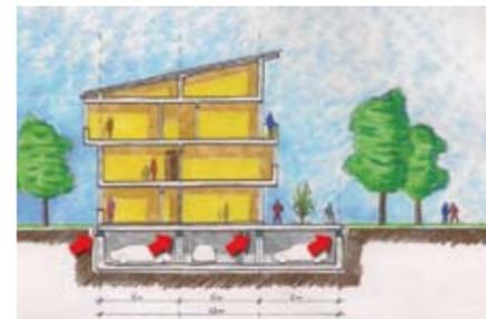
Schema tipico di un'unità abitativa del progetto C.A.S.E. a L'Aquila. Il progetto prevede la realizzazione di 150 unità abitative che ospiteranno 13.000 persone, simicamente isolate con l'impiego di 6000 isolatori a pendolo scorrevole. È probabilmente il più grande progetto di isolamento sismico al mondo.
