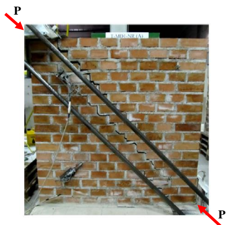
Figura 1. Prova di compressione diagonale (Gattesco e Boem, 2015).
