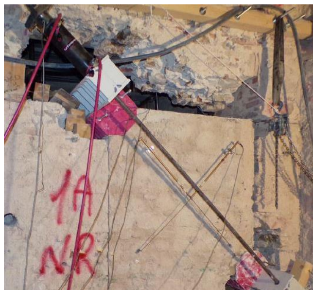
Figura 3. Allestimento di una delle 4 prove di compressione diagonale eseguita su un pannello di prova ricavato da una muratura esistente.
