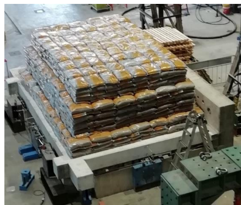
Figura 7. Esempio di applicazione del carico per la prova monotona fuori piano sul provino TA6.
