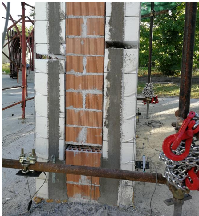
Figura 12. Apertura delle fessure nel campione M-1 durante l'esecuzione della prova.
