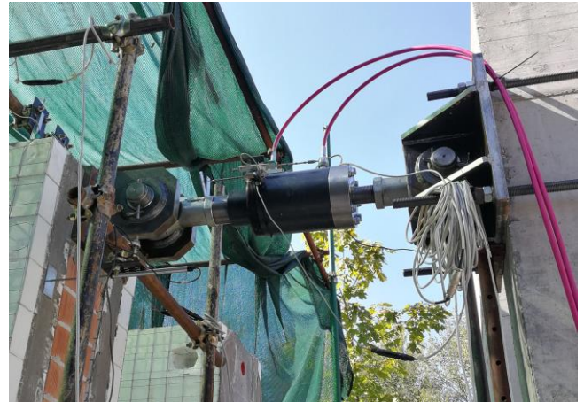
Figura 6. Foto del sistema di applicazione e misurazione della forza.
