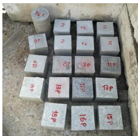
Figura 2. Campioni di cls per le prove di caratterizzazione meccanica.
