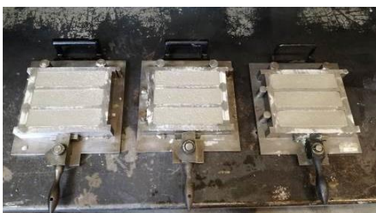
Figura 6. Provini di malta estratti durante la realizzazione delle tamponature.
