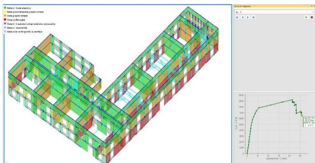
Figura 12. Rappresentazione stato di plasticizzazione per verifica a pressoflessione complanare al collasso (Distr. Forze (A), Direzione +Y) ottenuta da Aedes.PCM.
