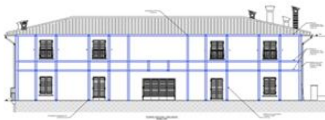
Figura 4. Prospetto frontale con aggiunta di fasce CFRP verticali.
