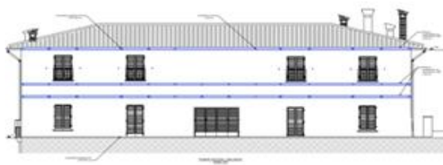
Figura 3. Prospetto frontale con aggiunta di fasce CFRP alla quota della fascia di piano terra.
