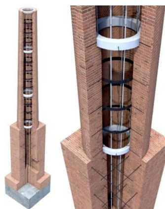
Figura 6. Schematizzazione dell'intervento di rinforzo.
