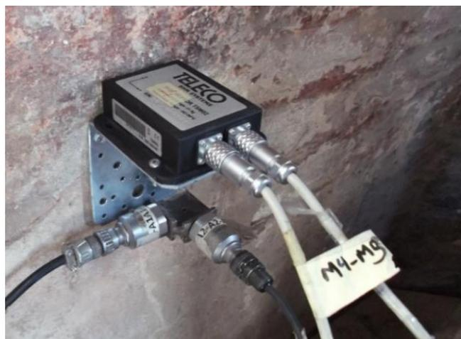
Figura 7. Tipica installazione dei sensori MEMS e piezoelettrici (livello L4).
