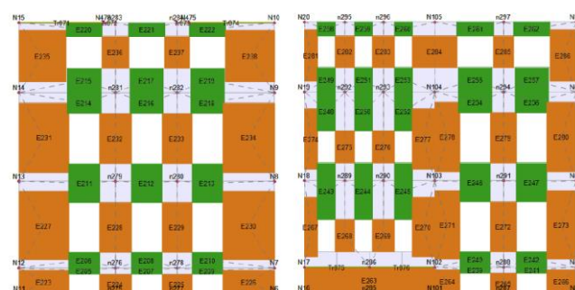
Figure 8. Mesh strutturali delle pareti 2 e 3 (si veda per la numerazione la Figura 5): in arancione i maschi, in verde le fasce e in azzurro i nodi rigidi.
