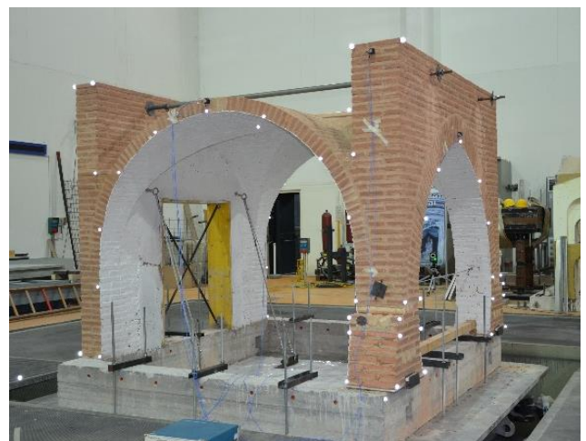
Figure 3. Prototipo testato su tavola vibrante. I marcatori del sistema di motion capture 3D sono visibili in bianco.
