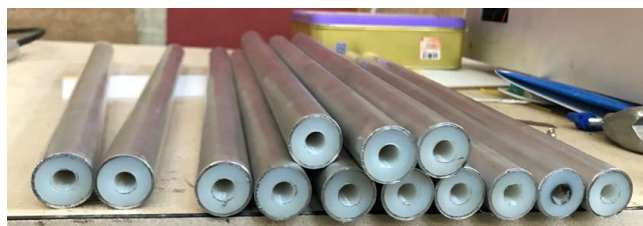
Figura 4 Tubi di alluminio utilizzati come pali di fondazione del modello di ponte
