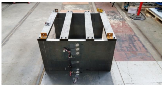
Figura 3 Modello di ponte integrale in scala utilizzato durante le prove.
