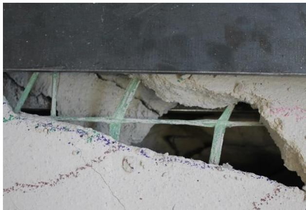
Figura 5. Modalità di rottura dei campioni rinforzati con rete in GFRP preformata.
