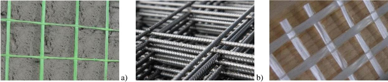
Figura 1. Reti di rinforzo impiegate nella sperimentazione: a) rete in GFRP preformata; b) rete elettrosaldata in acciaio; c) rete secca in fibra di vetro.
