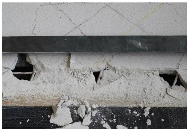
Figura 6. Modalità di rottura dei campioni rinforzati con rete elettrosaldata in acciaio.
