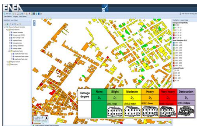
Figura 3. CIPCast-ES, danno atteso su singoli edifici, scala EMS98 (D0-D5)
